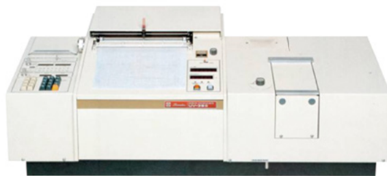
Fig. 8 Shimadzu UV-365 UV-VIS-NIR Spectrophotometer
