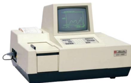
Fig. 7 Shimadzu UV-160 UV-VIS Spectrophotometer
